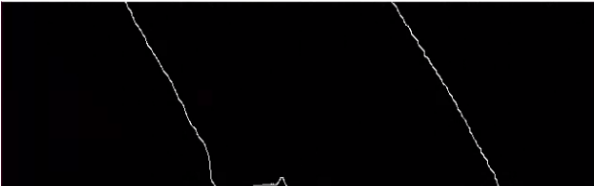
그림 4. Edge detection 을 통한 차선 검출
